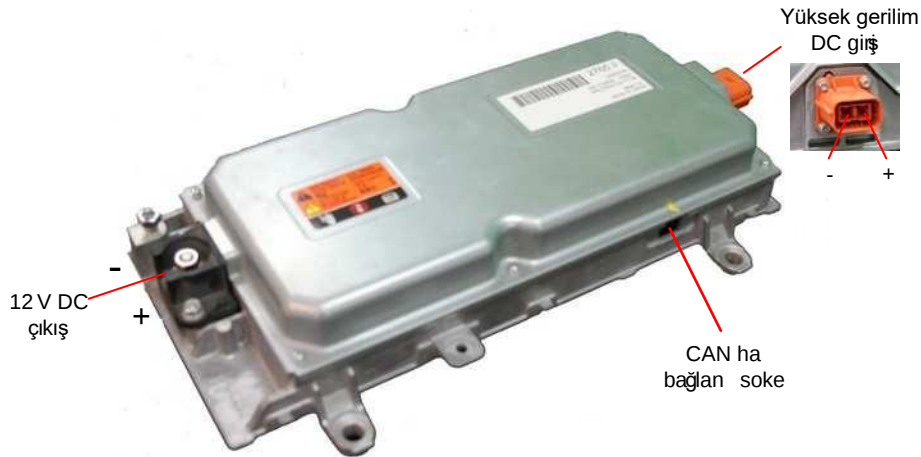
Görsel 1.22: Elektrikli bir araçta kullanılan DC-DC dönüştürücü
