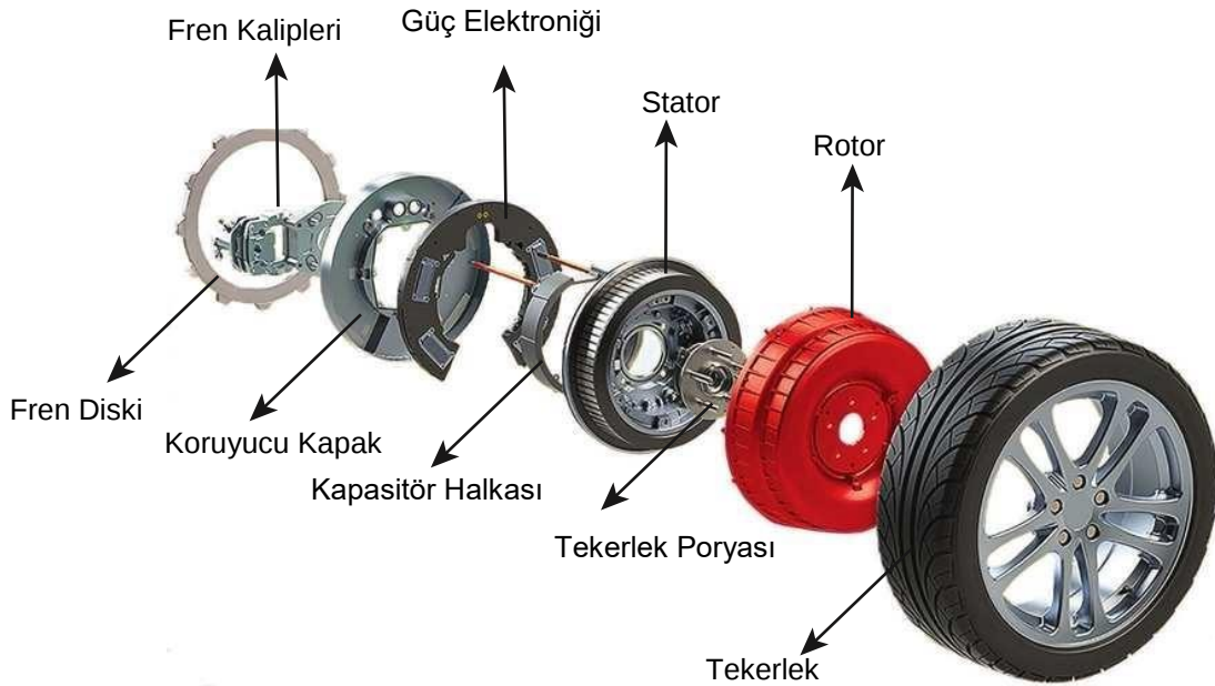
Görsel 5.4: Tekerlek içi motorun parçaları
