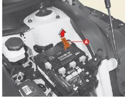
Görsel 2.1 : Elektrikli Araçlarda Yüksek Gerilimin Güvenli Şekilde Devre Dışı Bırakılması
