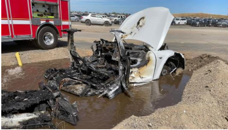
Görsel 4.10: Elektrikli Araç Batarya Yangını Sonrası Araç Gövdesi ve Söndürme Uygulaması
