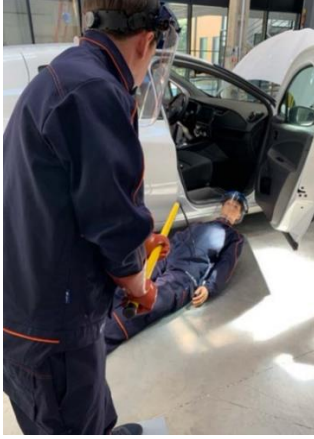
Görsel 2.4: Elektrikli Araçlarda Acil Durum Müdahalesi: İzolasyon Çubuğu ile Kurtarma
